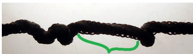
Ryc. 6. Fragment linki, który wygląda na sztywniejszy niż sąsiednie
